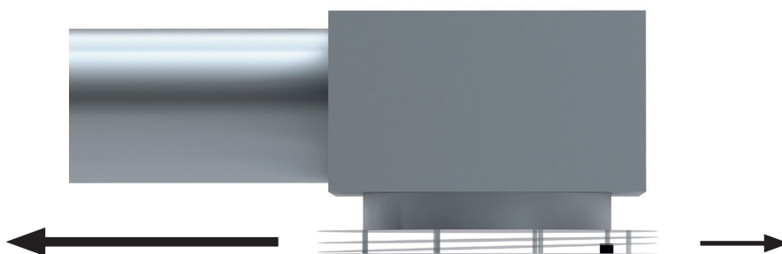
Justerad kastlängd genom placering av distans på stödben.
