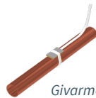
Givarmodulen monterad på rör
