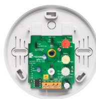
PDC-2400. Ekstern tilstedeværelsessensor 24VDC/VAC til loftmontering.
